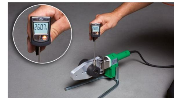
Temperaturmessung am aquatherm Handschweißgerät (800 W)
