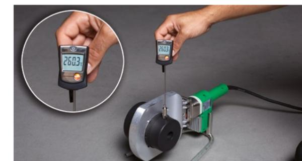
Temperaturmessung am aquatherm Handschweißgerät (1400 W)
