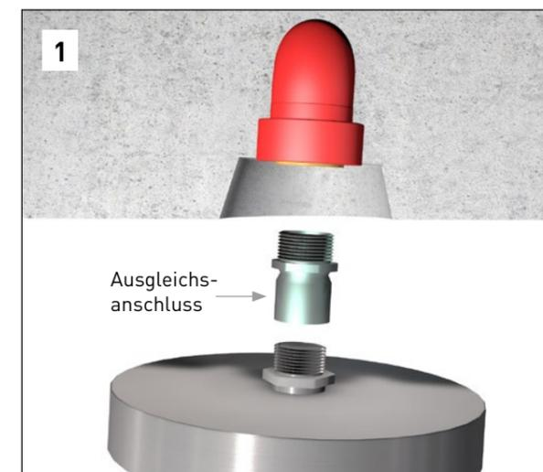
1) Sollte der Sprinkleranschluss schief aus der Betondecke stehen, ist es möglich, diesen mit dem Ausgleichsanschluss auszurichten. Der Ausgleichsanschluss wird mit dem dafür vorgesehenen 6-kant in das Sprinkleranschlussgewinde montiert. Eines der gängigen Abdichtverfahren zur Erstellung wasserdichter Gewindeanschlüsse ist zu verwenden.
