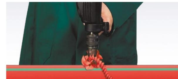
Durchbohren der Rohrwandung
