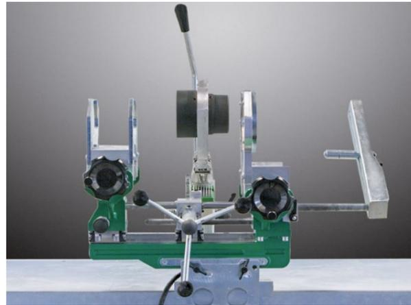
7. Schweißzeit laut Tabelle auf Seite 38 einstellen. Das Schweißgerät einbringen und mit der Handkurbel Fitting und Rohr bis zur Markierung langsam auf das Werkzeug aufschieben.
