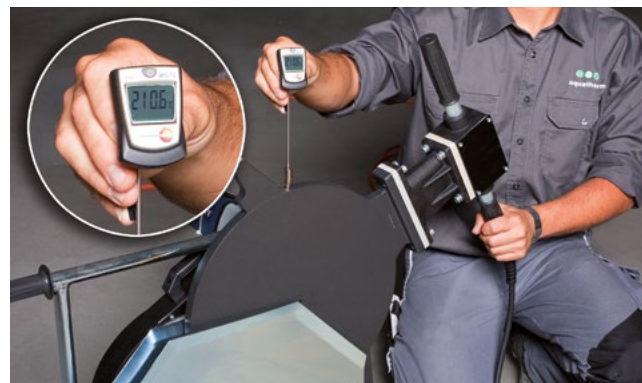
Temperaturmessung an aquatherm Stumpfschweißmaschine
