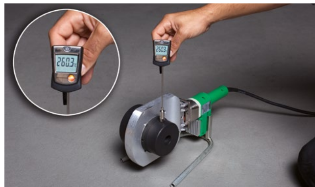
Temperaturmessung am aquatherm Handschweißgerät (1400 W)
