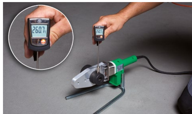
Temperaturmessung am aquatherm Handschweißgerät (800 W)
