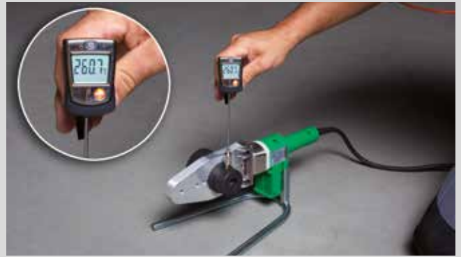
Misurazione della temperatura in un polifusore aquatherm (800 W)
