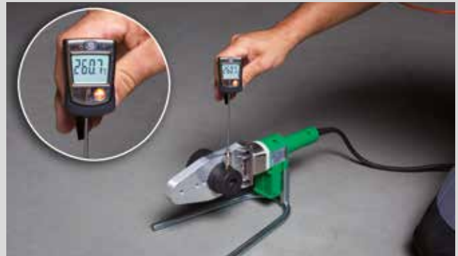
Temperaturmessung am aquatherm- Handschweißgerät (800 W)
