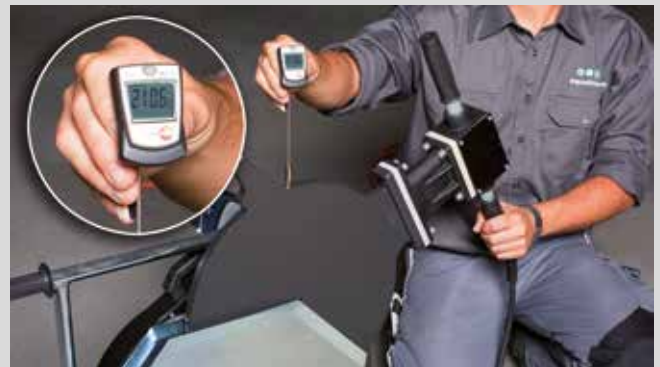
Control de temperatura – dispositivo de soldadura a tope aquatherm
