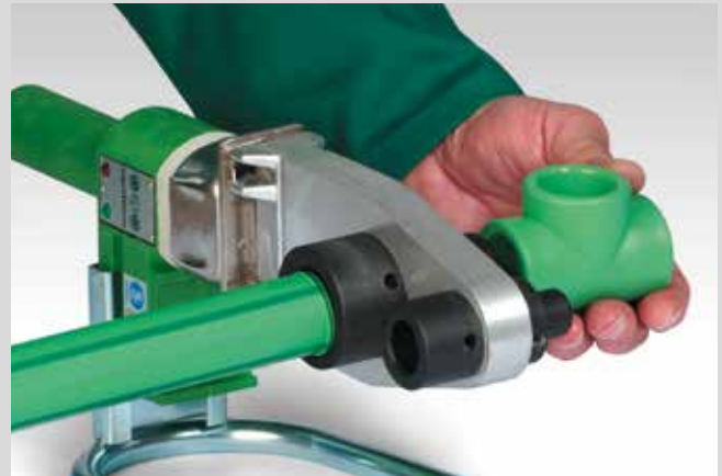
Anwärmen der Formteile
