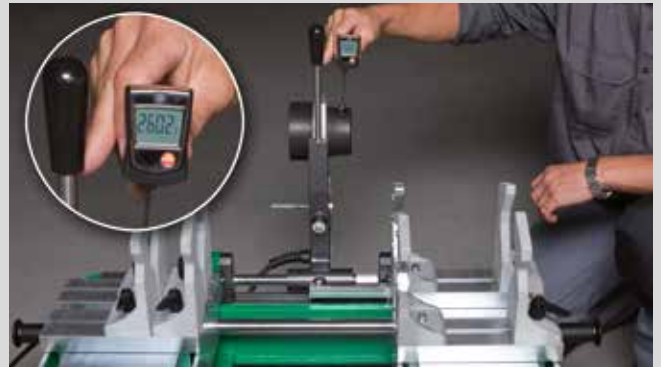
Misurazione della temperatura in una macchina per polifusioni aquatherm
