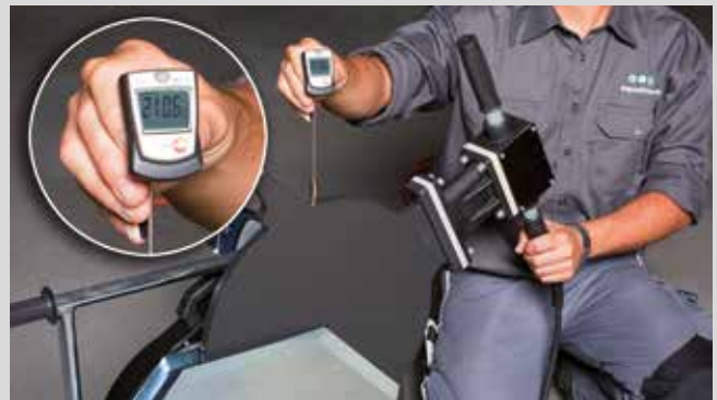
Temperaturmessung an der aquatherm- Stumpfschweißmaschine
