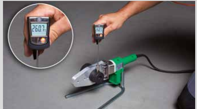
Control de temperatura – dispositivo de soldadura aquatherm (800W)
