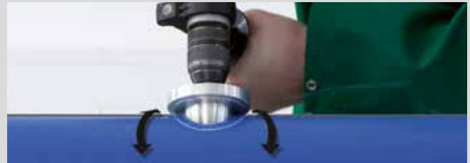
Entfernen der Sauerstoffspererschicht beim aquatherm blue pipe OT Rohr
