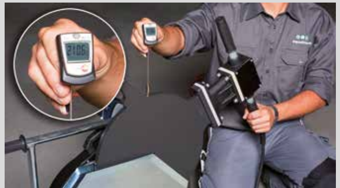
Misurazione della temperatura in un macchina per saldatura di testa aquatherm
